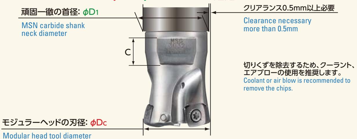
⚠️ 焼きばめホルダへの取り付け時の注意 Caution for the mounting to shrink fit holder.
